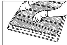
سپس با توجه به شکل روبرو به ترتیب نگهدارنده ها را به طرف داخل فشار دهید و آزاد کنید تا از بدنه مشبک جدا شود.
