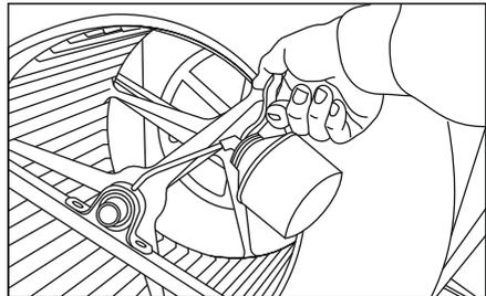
**هشدار: برای روغنکاری یاتاقان ها باید از روغن مخصوص (توربین ۱۰۰) استفاده شود.**
