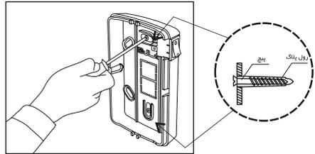
۲. قاب را بصورت مورب روی بدنه قرار می دهیم تا داخل شیار بالای قاب قرار بگیرد. سپس قاب را روی بدنه به طرف پایین حرکت داده و آنرا ثابت می کنیم.
