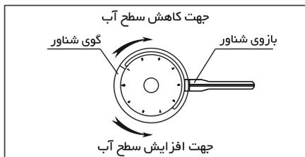
**هشدار: هنگام تنظیم ارتفاع آب باید با یک دست بازوی شناور را ثابت نگه داشته و با دست دیگر گوی شناور را تنظیم کنید.**
