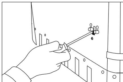
ج: با توجه به شکل زیر قفل نگهدارنده کلاهک پمپ آب را از بیرون کولر به طرف داخل فشار دهید. سپس زبانه های اتصال کلاهک پمپ را تا انتهای شکاف سوراخ آنها بالا آورده و به طرف داخل فشار دهید تا پمپ آزاد شود.
