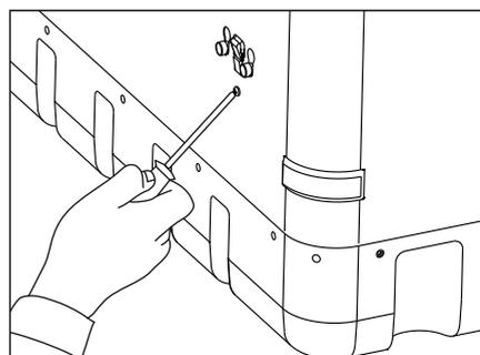
۶. پس از تمیز کردن پمپ و صافی آن، صافی پمپ را در جای خود قرار دهید.
